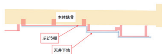
図 4.2 ぶどう棚工法の例
