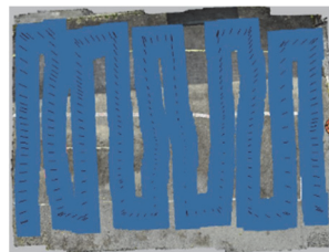
図-3 道路面の撮影位置
