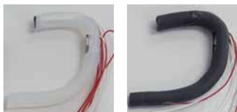
図3 試作耳かけユニット例 (9mm)。左：デュラブルレジン、右：フレキシブルレジン
