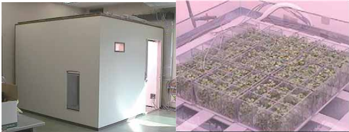
図 5 植物への 5.8GHz マイクロ波照射実験 (産総研, 2007 年)
