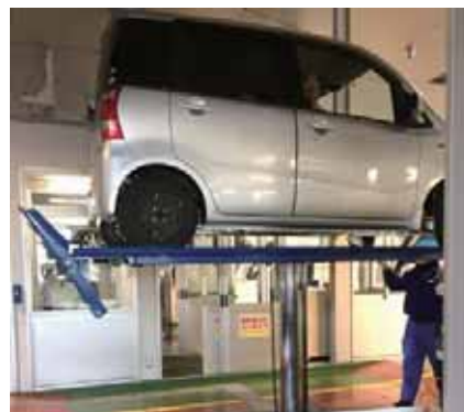
図12 検査官による 下回り検査
