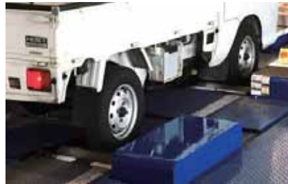
図6 ブレーキ検査の状況
