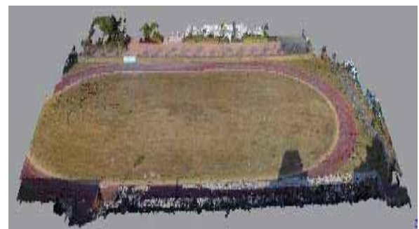
図-16 独立したキャリブレーション (標定点なし)
