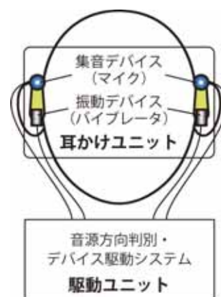
図1 補聴システム概略図
