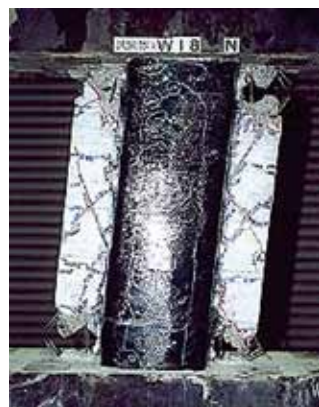
図-2 炭素繊維シートによる補強 (2)
