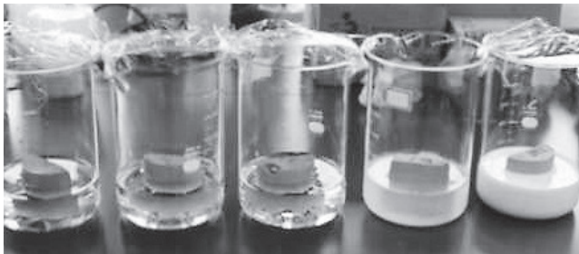
Fig.4 糖、カゼインおよび牛乳の浸透試験状況
