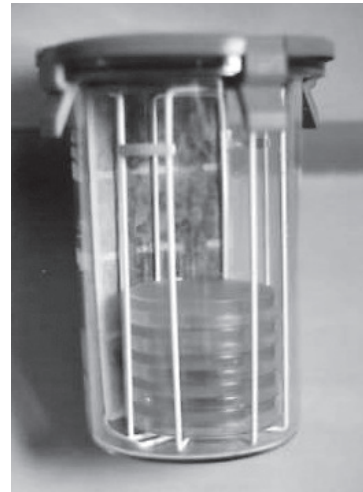
Fig.6 嫌気ジャーによる嫌気性菌の培養
