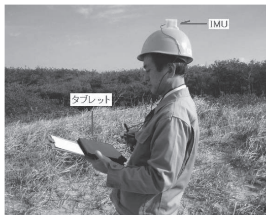
図-8 IMU 計測の様子
