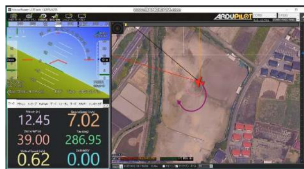
図 13. M/P による飛行状況モニター
