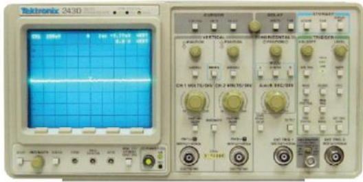
図2 オシロスコープの外観
