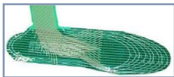
図2 インソール型圧力分布計測装置
