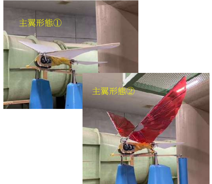
図.12 風洞セットアップ
