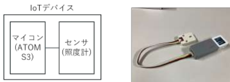
図 4 IoT デバイスの構成 (左：構成図、右：照度計を備えたマイコン外観)
