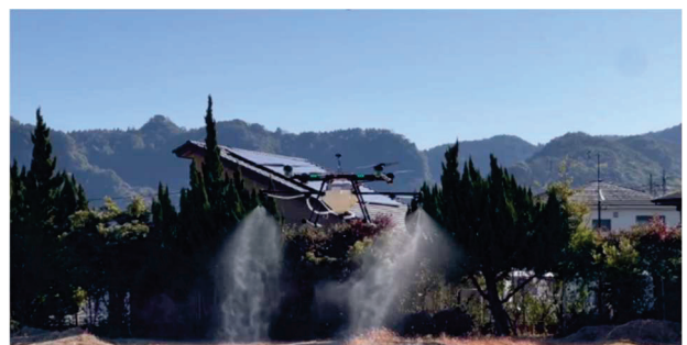
図.21 水散布飛行試験
