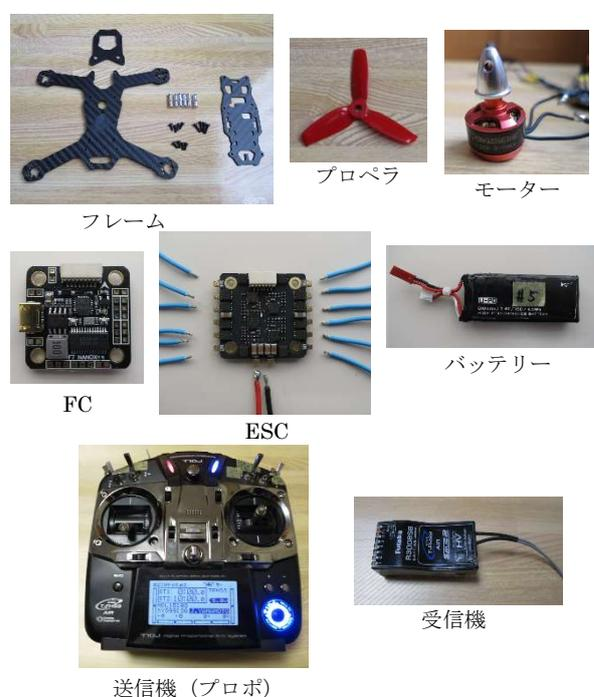
図 2. ドローン構成部品
