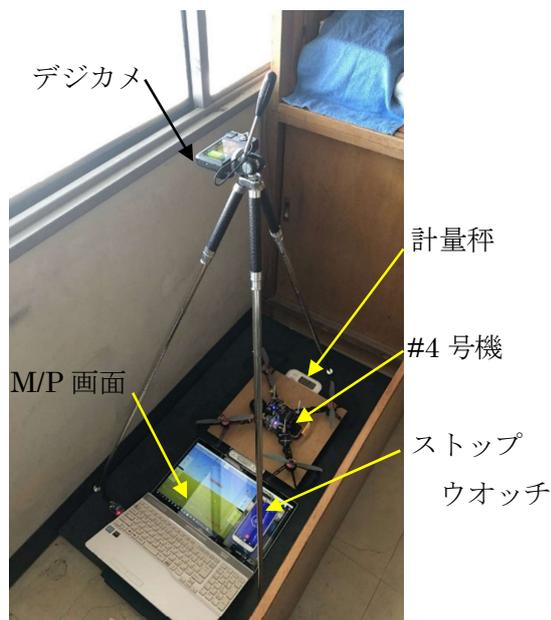
図 12. 静止推力・電力消費量測定状況
